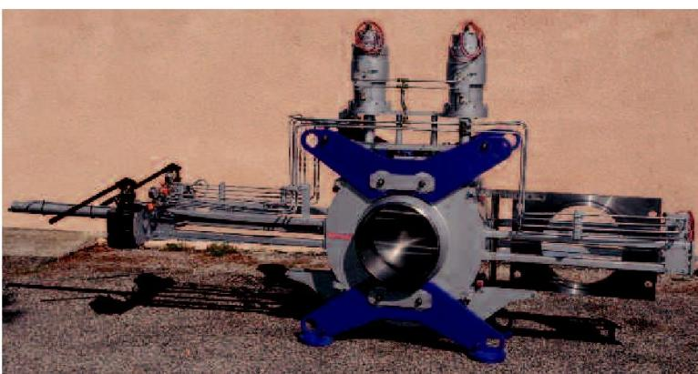
ONIS PL2V 18" 300#, приводится в действие дистанционно, с помощью гидравлического привода - FFCU, линия перекачки
