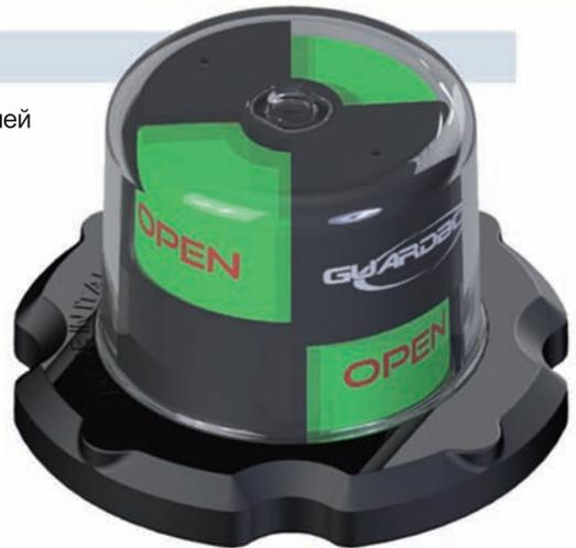
Трёхмерные индикаторы положения Guardbox полностью соответствуют всем указанным требованиям. Жёсткая конструкция способна выдерживать ударное воздействие предметов массой до двух килограмм, падающих с высоты до полутора метров при наихудших погодных условиях и окружающей температуре до минус 60°C.
