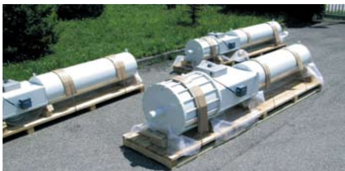
СИММЕТРИЧНАЯ КУЛИСА (ПРУЖИНА ЗАКРЫВАЕТ)
