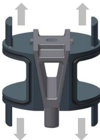
Опция 2: Демонтаж пробки снизу
