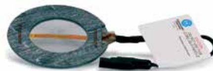
Индикатор разрыва мембраны BDI позволяет отследить момент разрыва мембраны. В основе индикатора разрыва лежит электрический проводник. В момент разрыва мембраны изменение в состоянии электрической цепи может отслеживаться на пульте системы управления или же по месту с помощью сигнальной системы.
