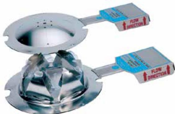
**Мембрана разрывного типа (прямого действия)** работает на разрыв под давлением, действующим на ее вогнутую поверхность. При превышении давления над допустимым рабочим мембрана начинает растягиваться. Из-за повышения давления растяжение будет продолжаться до тех пор, пока не будет достигнут предел прочности, и мембрана не разорвется.
