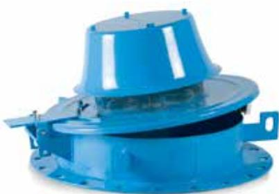
Основной функцией аварийного предохранительного клапана является обеспечение сброса большого объема рабочей среды для защиты резервуара от разрыва при росте избыточного давления в случае возникновения внешнего пожара.
