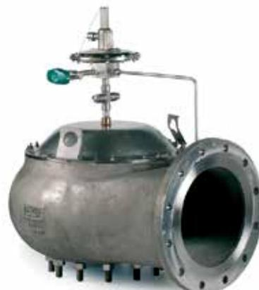
Импульсные предохранительные устройства предназначены для надежной защиты резервуаров низкого давления от образования избыточного давления и (или) вакуума. Давление полного открытия достигается уже при повышении установочного давления на 10%. В результате исключается необходимость в обеспечении 100% сверхдавления от давления настройки, что позволяет сохранять продукт и снижать объемы потерь продукта.
