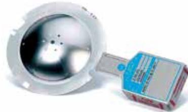
Composite – разрывная мембрана разработана специально для защиты систем на меньшие давления срабатывания по сравнению с другими мембранами разрывного типа. Исполнение с семью отверстиями в центре обеспечивает разрыв мембраны без образования осколков при использовании уплотнения из Тефлона.
