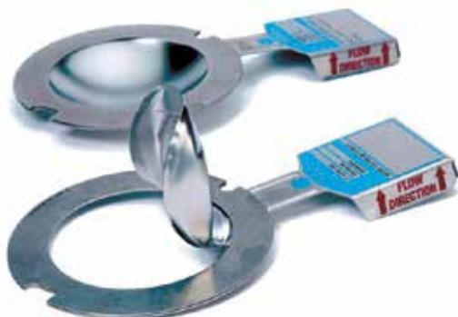
**Мембрана хлопающего типа (обратного действия)** работает на разрыв под давлением, действующим на ее выпуклую поверхность и приводящим к её сжатию. При достижении диапазона давления разрыва сжимающая сила будет стремиться выгнуть диск и вызвать его разрыв по предварительно ослабленному сечению.
